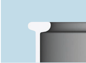
Flange ½ Flange width 2.6 mm
